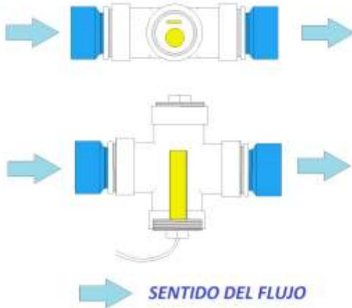
El electrodo instalado en la Cámara, debe tener la posición que indica la figura, donde ambas barras deben estar perpendiculares al Flujo de agua de manera de asegurar un barrido de iones para que estos lleguen al agua. En caso de que la posición es como reemplazo de un codo (foto superior), el electrodo quedará con ambas barras enfrentando al flujo de agua manteniendo el sentido de trayectoria del mismo.
