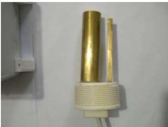
**Set de electrodos de desgaste:** Los electrodos en contacto con el agua son barras de una aleación de Cobre y Zinc. La inducción de corriente hace que gradual y controladamente se emitan iones al flujo de agua, lo que será transmitido por el sistema de filtrado al agua de la piscina, estanque o pileta, según sea el caso. El desgaste provocado por la emisión hace necesario el reemplazo de la pieza, una vez cumplida su ida útil de uso.
